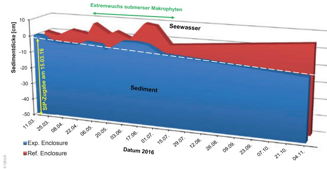
**Bild 5:** Änderung der Sedimentdicke im Experimental-Enclosure der oberen 0,5-m-Schicht, die mit SIP behandelt wurde, im Vergleich zum unbehandelten Referenz-Enclosure im Caohai-Testteich des Dian-Sees, China
