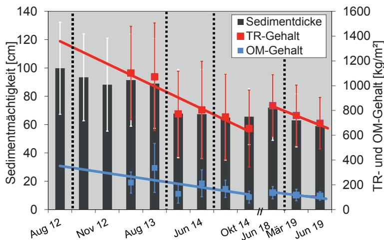
**Bild 3:** Zeitlicher Verlauf von Sedimentdicke (linke y-Achse), Gehalt an Trockenrückstand (TR) und organischer Materie (OM) (rechte y-Achse), beeinflusst durch die SIP-Dosierung (gestrichelte Linien) im Mühlenteich
