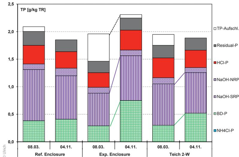
**Bild 6:** Änderung des TP-Gehalts und der P-Fractionen in der oberen 0,5-m-Sedimentschicht, die im Experimental-Enclosure und Caohai-Testteich mit SIP behandelt wurde, im Vergleich zum unbehandelten Referenz-Enclosure
